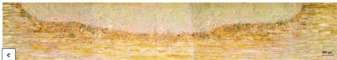
Obr. 2: Makrostruktura průvaru duplexní korozivdorné oceli LDX 2101
