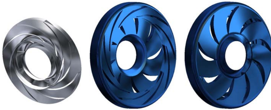
Obr. 3. 3D geometrie oběžného kola a statoru čerpadla 150CHM
